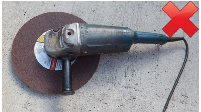
切勿將超大的光盤安裝到研磨機上
